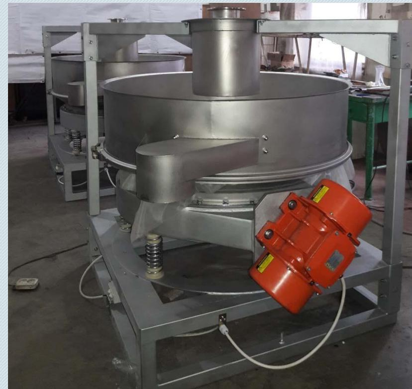
Вибросито ВВУ2.1200.1ВЧ двухмоторное однодечное предназначено для контрольного грохочения продуктов переработки кальция.
